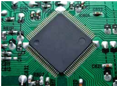
0.5mmピッチ100ピンQFP搭載基板、ブリッジのないフローはんだ付ができます。
